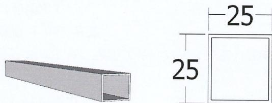
(铁床爬梯立柱效果示意图) (铁床爬梯立柱截面尺寸图)
