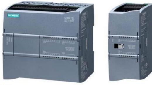
IO 14 入、10 出，100 KB 工作存储器；24VDC 电源。板载 DI14 ×24VDC 漏型/原型 DQ10 x24VDC 和 AI2 :板载 6 个高速计数器和 4 路脉冲输出；信号板扩展板载 I/O，多达 3 个用于串行通信的通信模块，多达 8 个用于 I/O 扩展的信号模块：0.04ms/1000 条指令；PROFINET 接口，用于编程、HMI 以及 PLC 间数据通信。配套相应的 PLC 编程软件。
