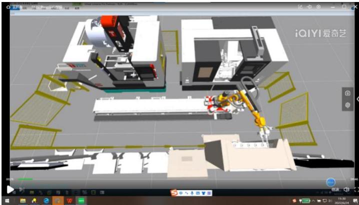
3) 根据订单情况，选择机床进行上下料（车床或加工中心）。
