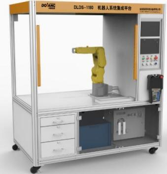
工业铝型材结构，总尺寸  $1740 \times 1020 \times 1950\text{mm}$ 。主要承重采用 60mm 优质工业铝型材，安装面板厚度为 30mm 铝合金型材，带有 25mm 的槽间隙。合金 6063T5；表面处理氧化、平光、电泳、镀膜。所有基础操作考核模块均可快速在此通用面板上安装，节约实训时间。
