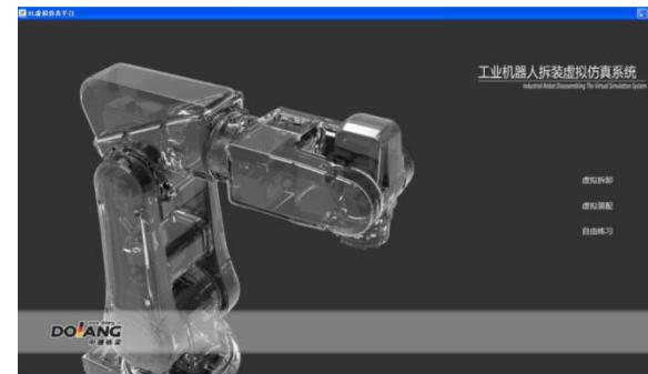
1) 采用 3D 技术与交互式动画相结合的方式，仿真拆装工业机器人机械结构，通过对机器人的 3D 模拟仿真拆装训练，可以在线将每个轴拆卸成独立的零部件，让学生掌握工业机器人的硬件组成、机器人结构分析、机器人电机安装、RV 减速器、谐波减速器安装等机器人安装技能。
