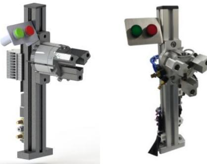
主要由铝制安装底座、铝型材基体、铝制卡盘安装座、平行开闭行三爪气动卡盘、红色指示灯、绿色指示灯、L型指示灯支架、接线端子、M12插头、磁性开关（2个）、电磁阀等组成。
