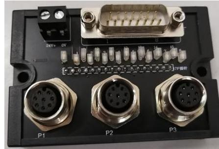
该智能连接器，可显示电源指示灯、信号指示灯，配有快速插接插头。将设备线路信号集成转换到另外的负载接收模块，进行信号的数据交换。每输入或输出一个信号对应一个指示灯显示，通过信号指示可快速的判断信号的有无，便于调试维护，从而大大提高了工作效率。
