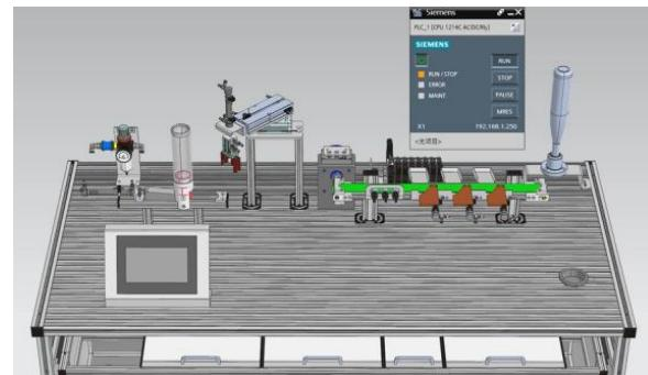
2) 搬运单元：搬运伸缩气缸原位→搬运气缸伸出→搬运伸缩气缸到位→搬运升降气缸原位→搬运升降气缸下降→下降到位→气手抓抓取→抓取到位→搬运升降气缸上升→上升到位→搬运旋转气缸原位→搬运旋转气缸右移至放料位置→搬运旋转气缸右移到位→搬运气缸伸出→搬运伸缩气缸到位→搬运升降气缸下降→下降到位→气手抓松开→搬运升降气缸上升→升降气缸上升到位→搬运伸缩气缸缩回→旋转气缸左移至取料位置→搬运完成。
