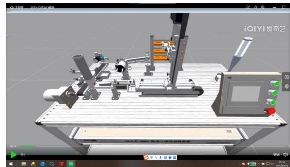
4) 仓储单元：判断物料的材质及颜色→X 轴移动至物料抓取位置
