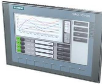
与 PLC 同一品牌，采用 9 寸真彩触摸屏，800 x 480 像素，64K 色；按键和触摸操作，8 个功能键；1xPROFINET，1 x USB；与 PLC 采用以太网通讯。
