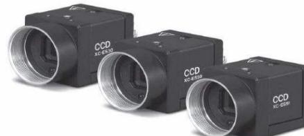
由工业相机、摄像头、安装支架等组成。能够完成装配是否成功的识别及定位工件等功能。具有形状识别和颜色识别。具体
