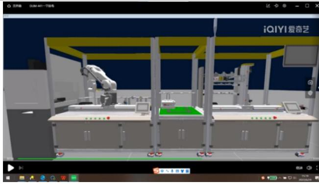
5) 工业机器人单元及 RFID 读写单元：视觉检测完成后 RFID 进行信息更新，更新完成后机器人搬运成品放置到缓冲工位。
