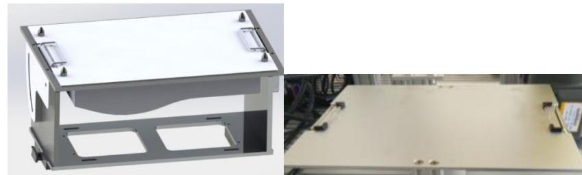
该模块主要由支腿、曲面绘图板等组成，支腿可调角度，曲面绘图板为一体两面，一面为曲面轨迹，图案有阿基米德线、菱形、三角形等，主要功能是训练复杂曲面轨迹编程，一面为绘图区，绘图区两侧有纸夹，可以更换纸张。机器人以笔形绘图夹具描绘图形，训练对机器人基本的点示教，直线、曲线运动足迹的掌握，学习点的定位及机器人运动路线选择优化。
