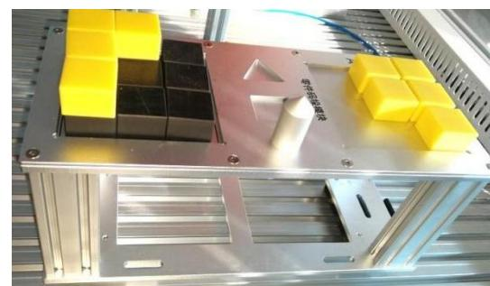
物料块有圆柱形和正方形两种，配置吸盘夹具，主要训练机器人搬运指令及码垛指令。
