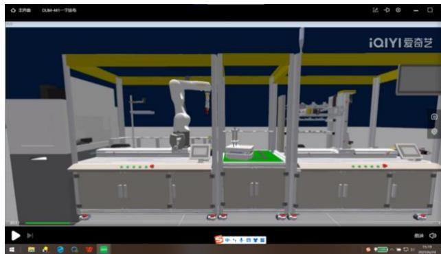
2) 工业机器人单元及 RFID 读写单元: 机器人抓取 AGV 单元缓冲工位中的托盘及毛坯物料, 放置到 RFID 读写器上方, 进行信息
