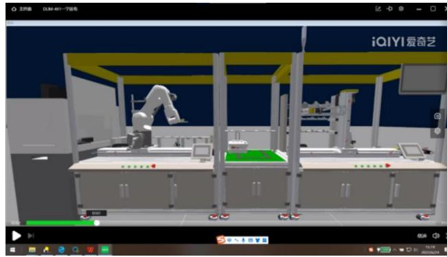
3) 加工中心单元：读写完成后机器人抓取毛坯料进行机床上料，上料完成后加工中心进行加工、在线测量，测量完成后机器人进行加工件下料。
