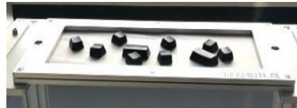
外形尺寸355\*160mm、铝合金喷砂氧化。用于按键存放，能配合视觉系统，考核机器人视觉检测，完成视觉定位抓取。
