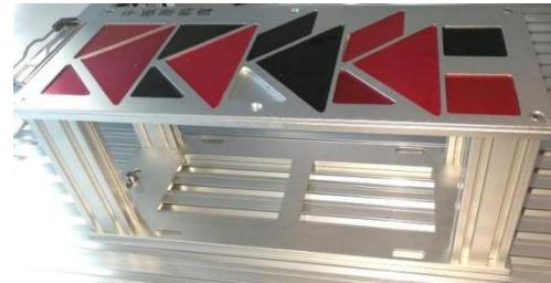
由铝合金支撑架、面板、各种大小三角形、矩形、平行四边形等零部件（红黑两种颜色）组成。配合工业机器人完成模拟切割、搬运、拼图等训练内容，同时也可做为视觉检测对象用于机器视觉相关知识的学习与训练。
