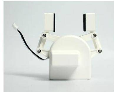
平行夹爪能通过可编程系统控制机械臂的末端执行器，实现物件的抓取、多点定位等功能。
