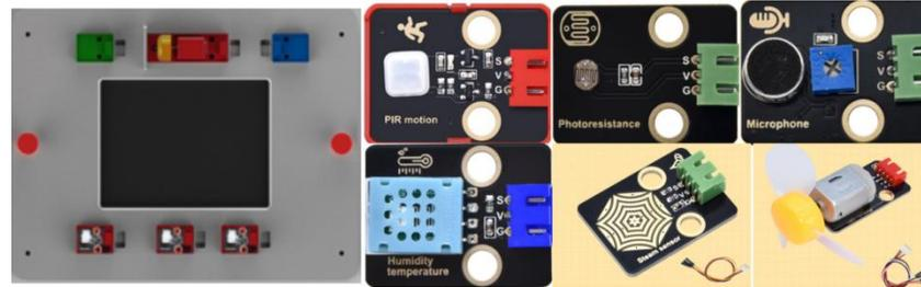
智能家居模块包含温湿度传感器、人体红外热释传感器、光敏电阻传感器、声音传感器、DHT11 温湿度传感器、水滴传感器，以及一个电机模块。
