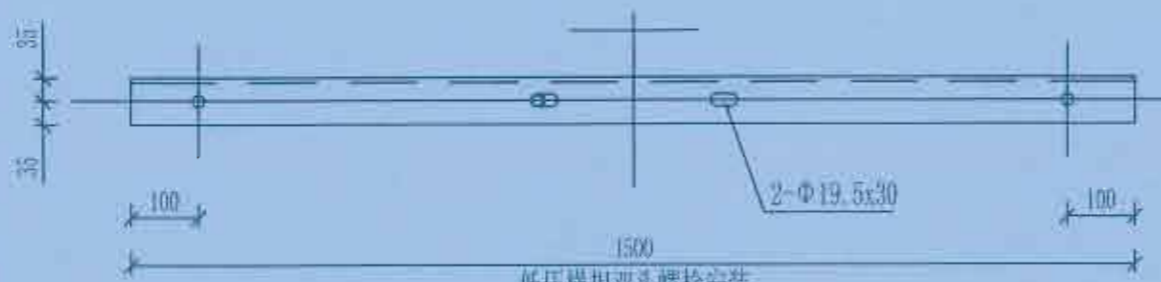
低压横担双头螺栓安装 孔加工图
