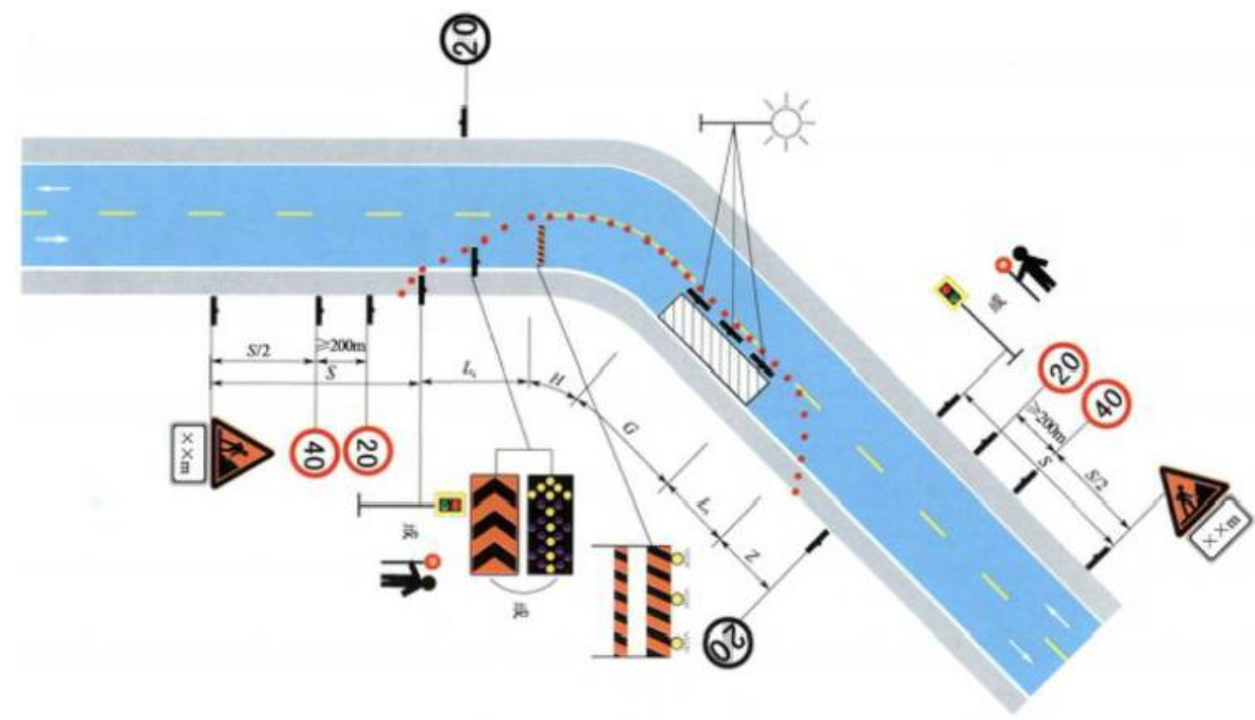
(三) 弯道后路段临时养护作业示意图
