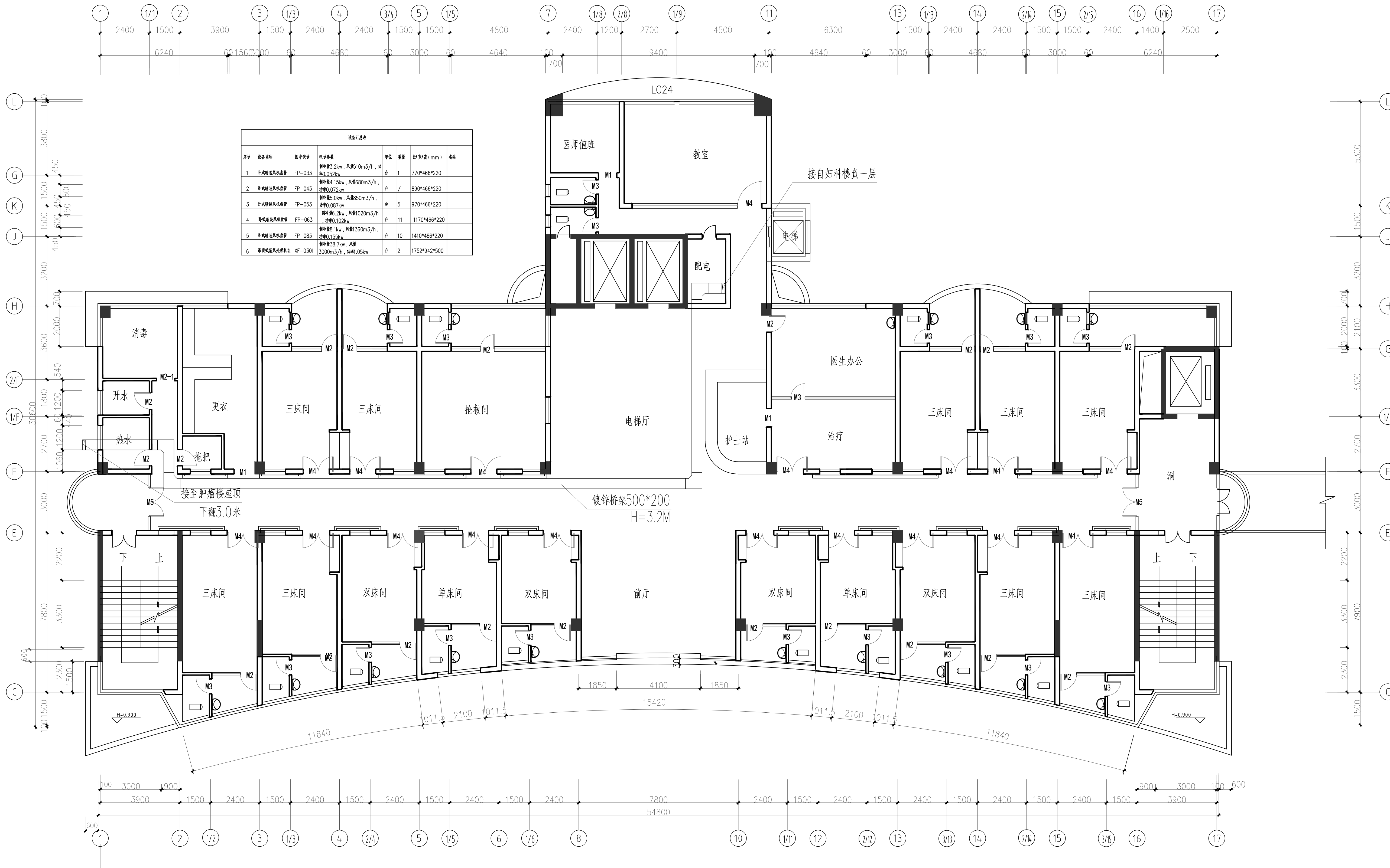
妇科楼七层新增空调电气桥架平面布置图 1:150
