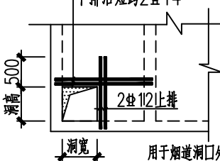
图5-4 烟道底层、及每层洞口边加强
