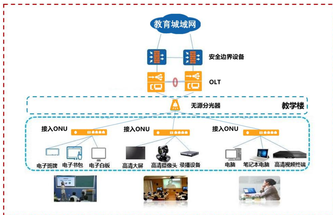
图 5-20 校园网网络架构方案二
