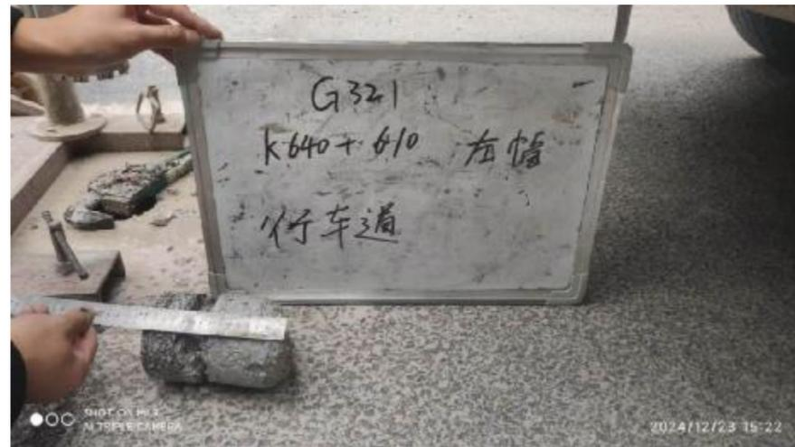
行车道处取芯, 实测各结构层厚度为 70 (mm) +15 (mm), 沥青面层成型但不完整, 基层成型但不完整。
