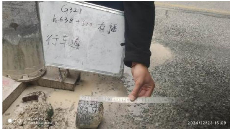
行车道处取芯, 实测各结构层厚度为 70 (mm) +15 (mm), 沥青面层完好。
