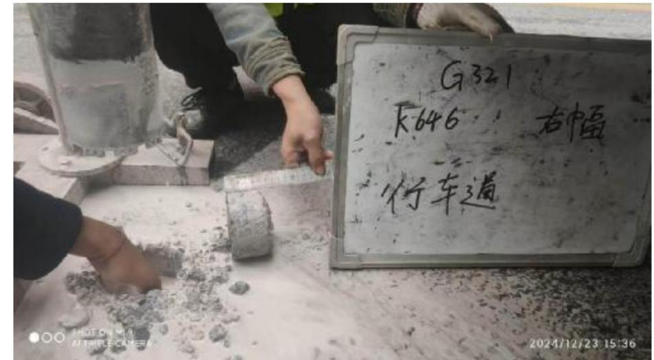
行车道处取芯, 实测各结构层厚度为 70 (mm) +15 (mm), 水稳基层不成型。
