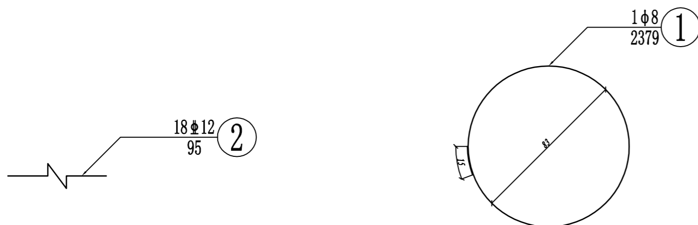
管节外侧环筋的横断面图(1:20)
