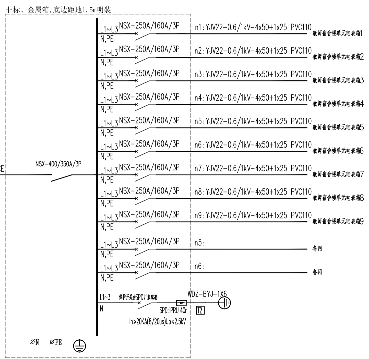
新装教师楼宿舍楼配电总箱 (共1个) 注: 安装于一层宿舍楼侧面
