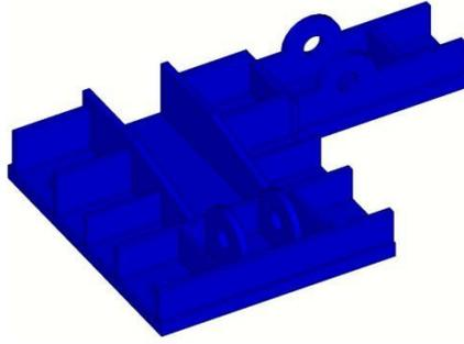
图 7a. 角柱柱脚 1 三维示意图
