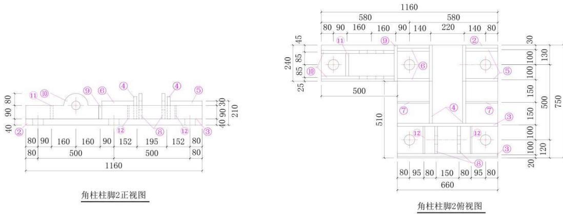
说明: 1. 所有零件之间均采用双面角焊缝连接;
