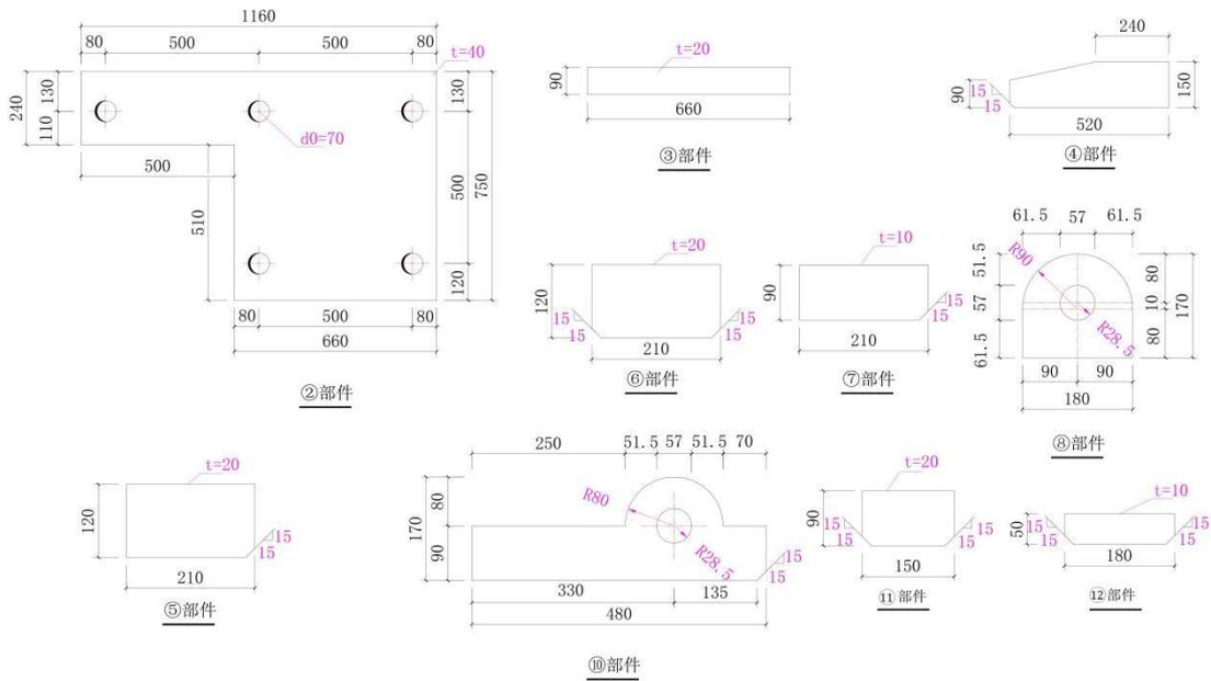
图 8c. 角柱约束端 2 各部件详图
