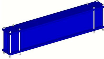
图 2a. 二级分配梁三维示意图
