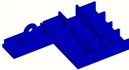
图 8a. 角柱柱脚 2 三维示意图
