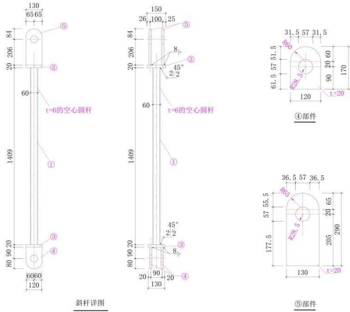
说明：1. 所有零件之间均采用双面角焊缝连接；
