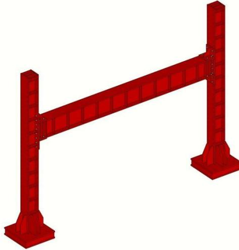
图 15a. 门式反力架三维示意图
