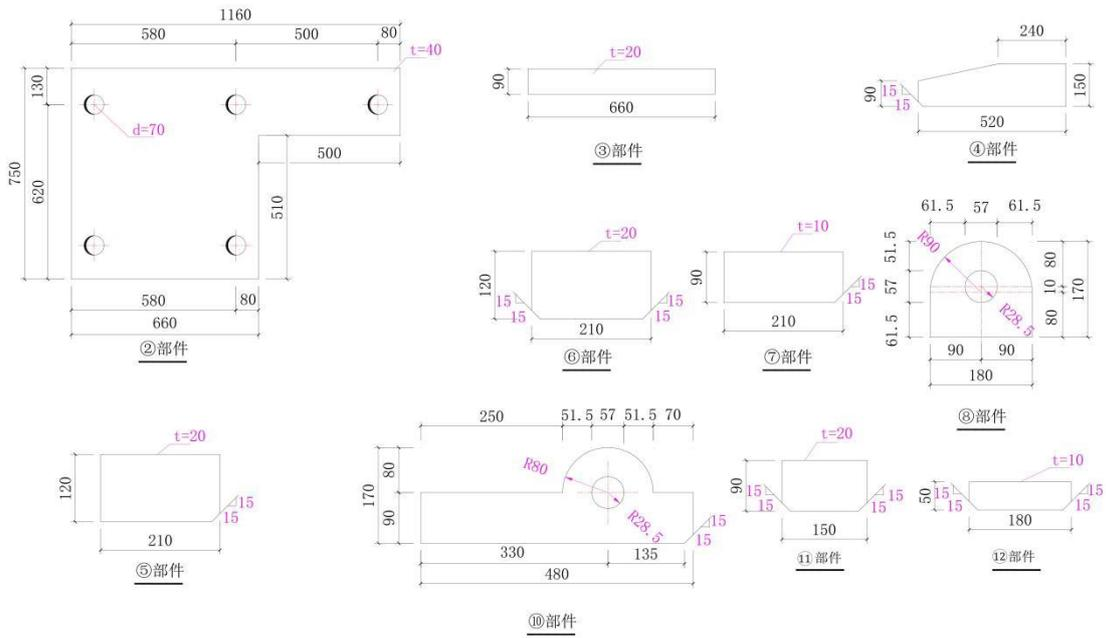
图 7c. 角柱柱脚 1 各部件详图
