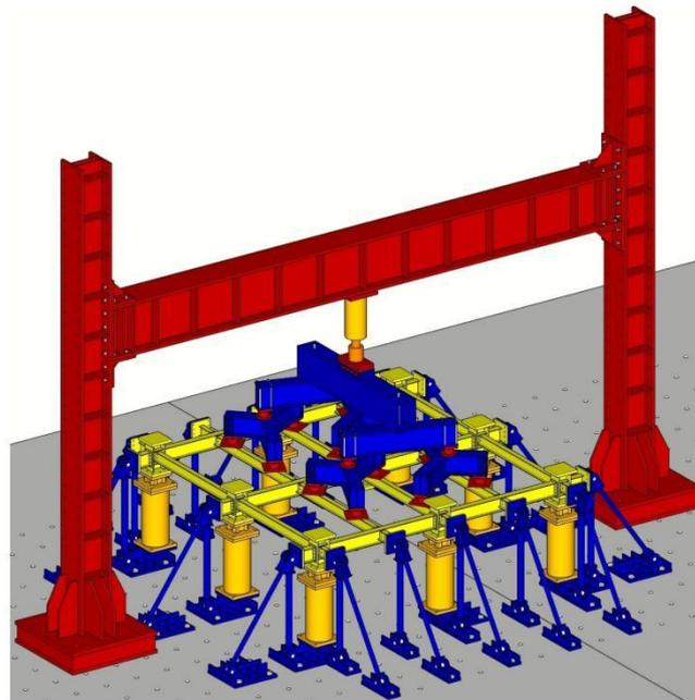
图 16. 整体三维示意图 (图内试件不包含在内)
