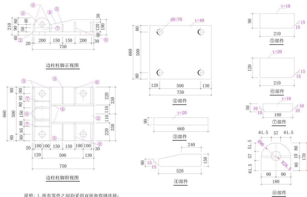
图 6b. 边柱柱脚 1 详图
