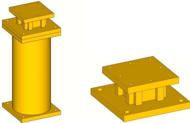
图 4a. 钢管混凝土柱和转换头三维示意图
