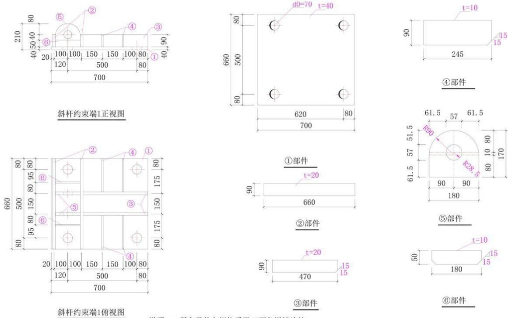
说明: 1. 所有零件之间均采用双面角焊缝连接;
