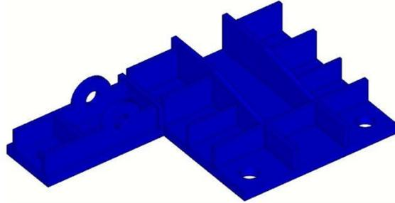
图 10a. 边柱柱脚 2 三维示意图
