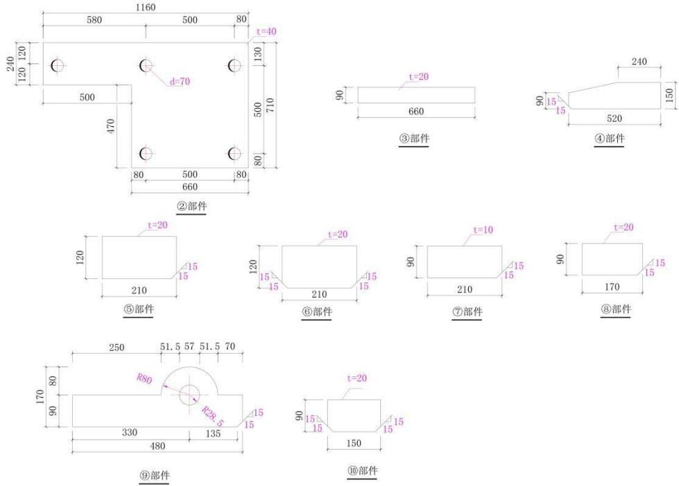
图 10a. 边柱柱脚 2 各部件详图
