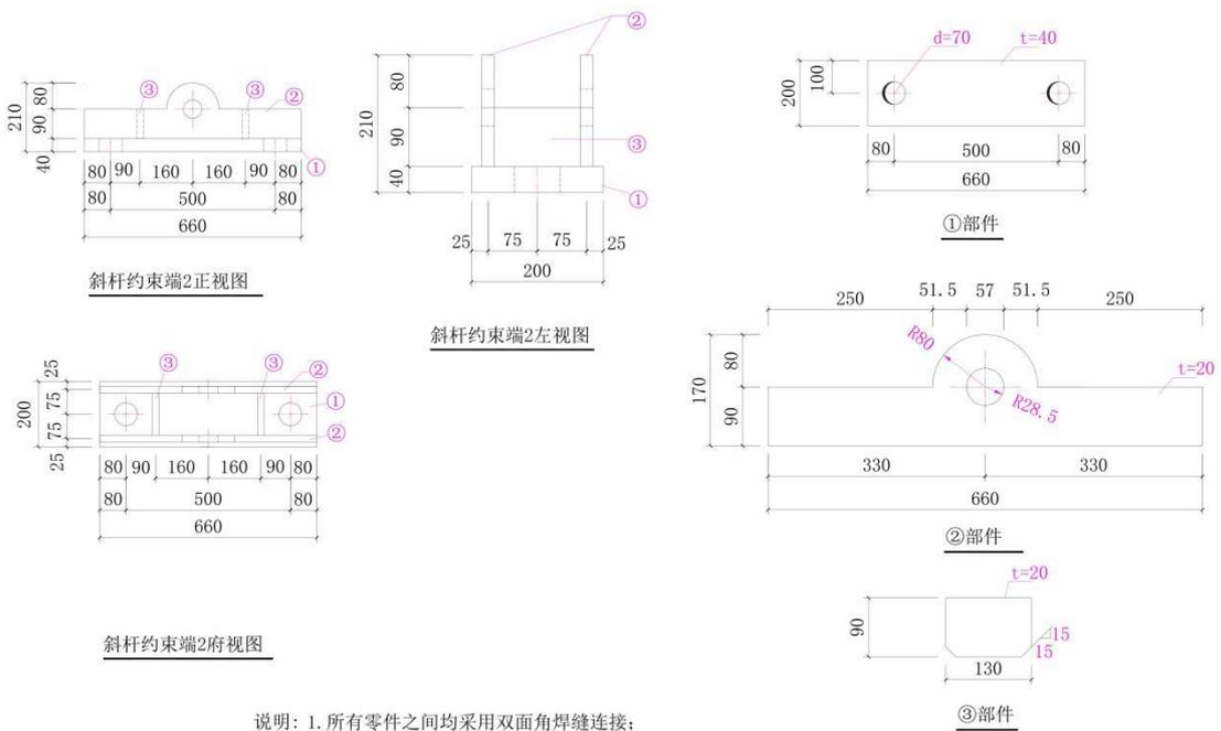
图 9b. 斜杆约束端 2 详图
