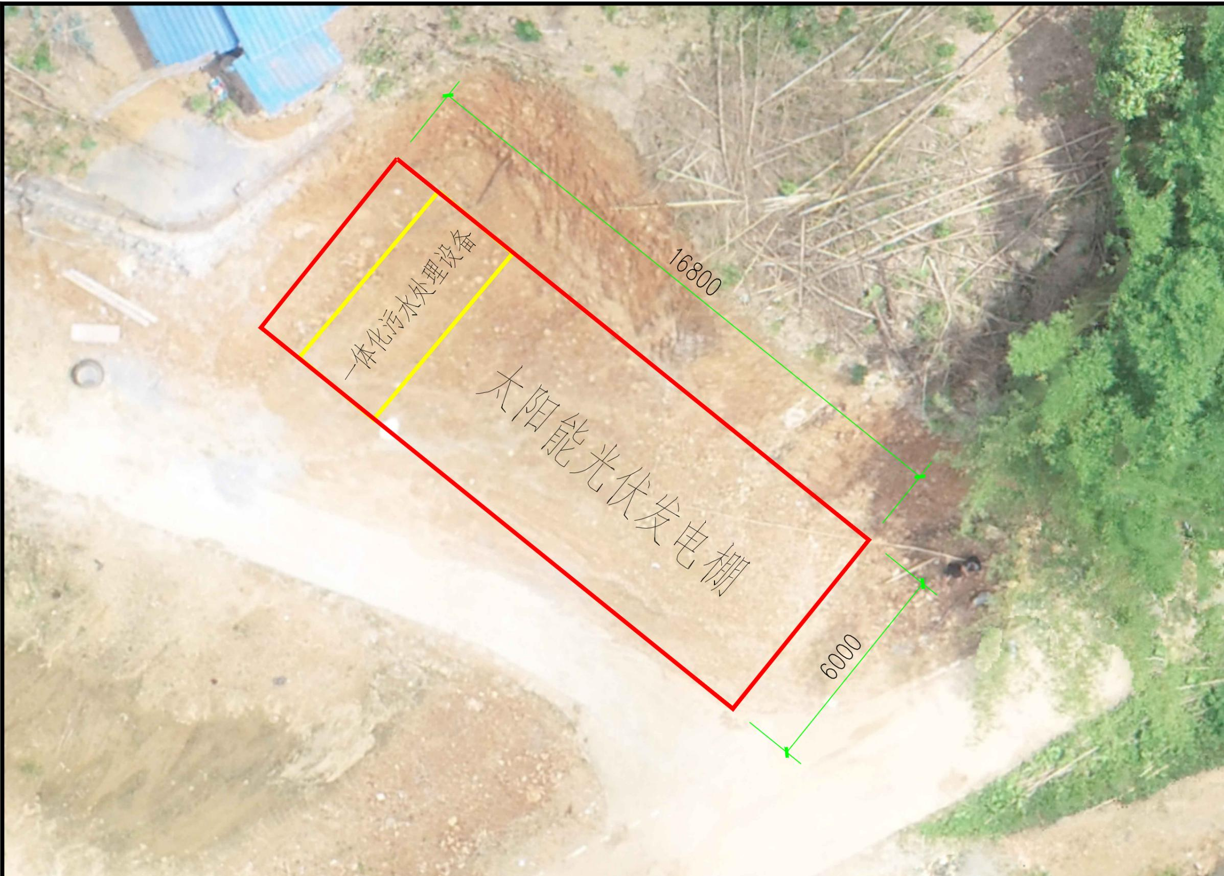
一体化污水处理设备和光伏发电棚平面图平面布置图 1:100
