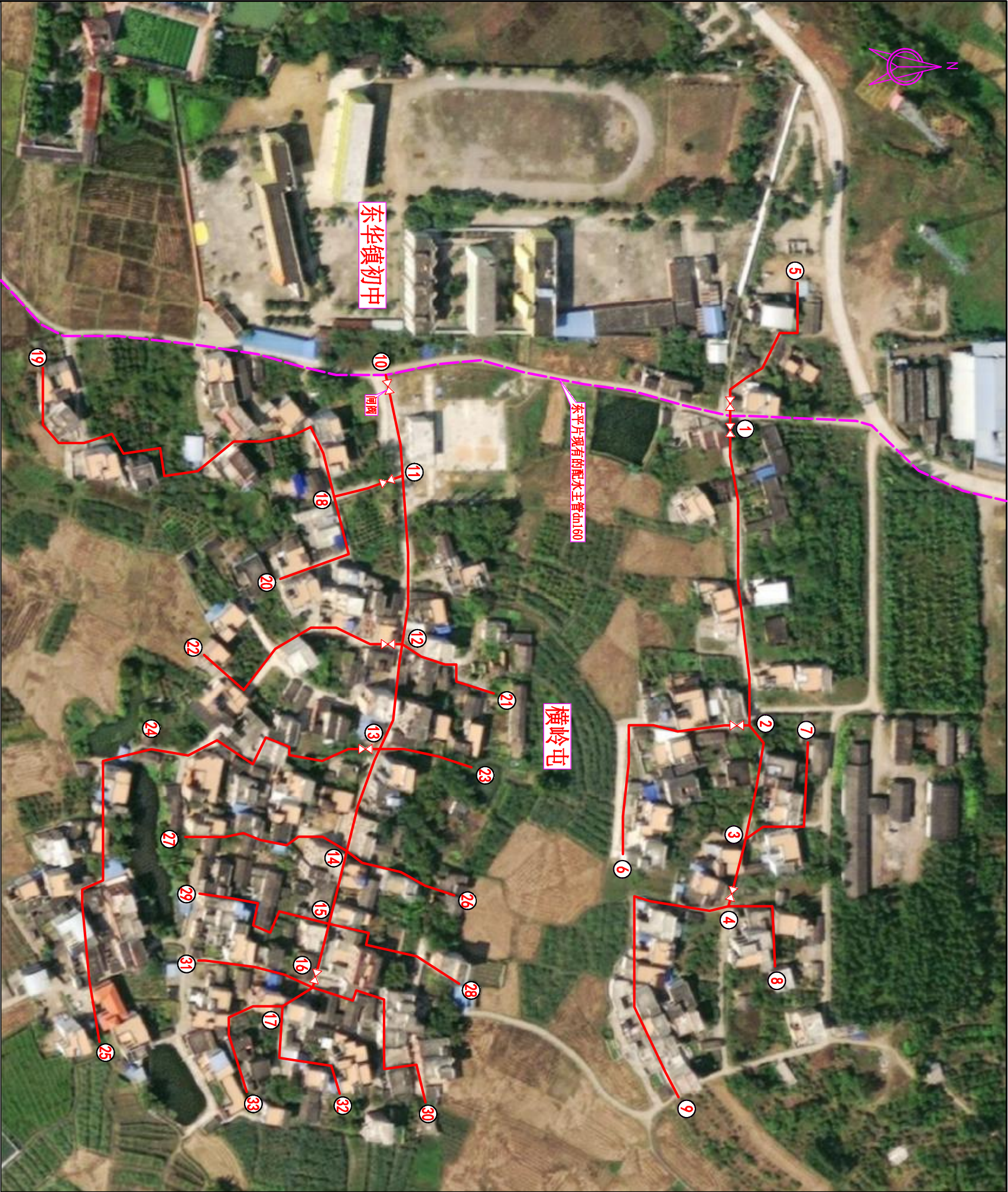
横岭屯配水管网改造平面布置图
