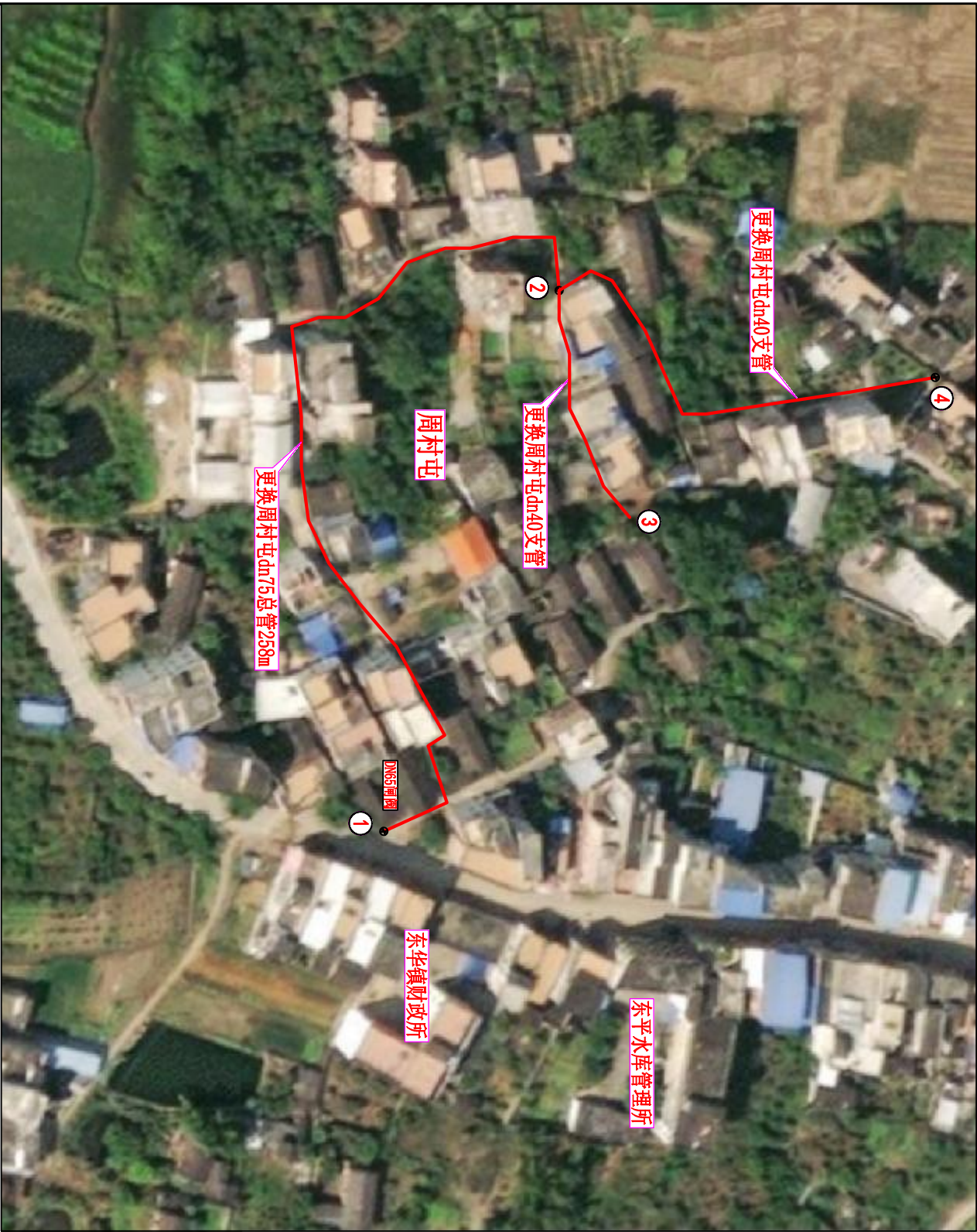
周屋屯配水管网改造平面布置图
