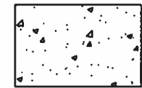
新建水泥混凝土面层
