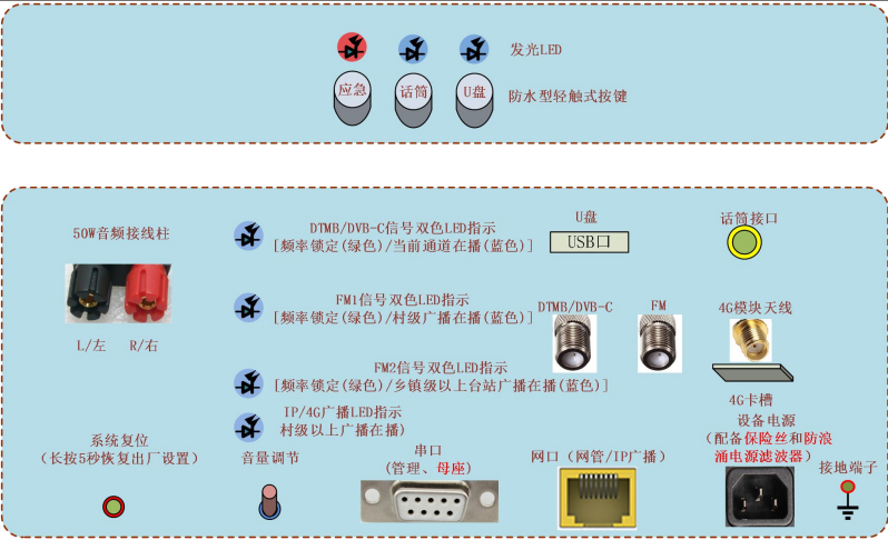
收扩机接口示意图（前面板和底部）
