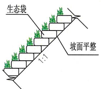
生态袋护坡断面图 1:50
