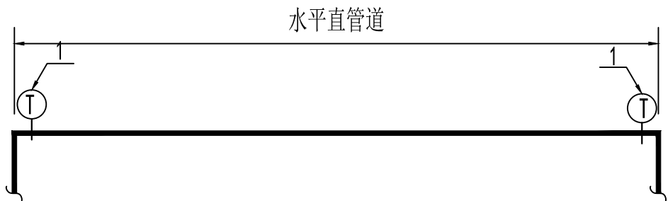
图1 水平直管段抗震支架设置 1— 抗震支架
