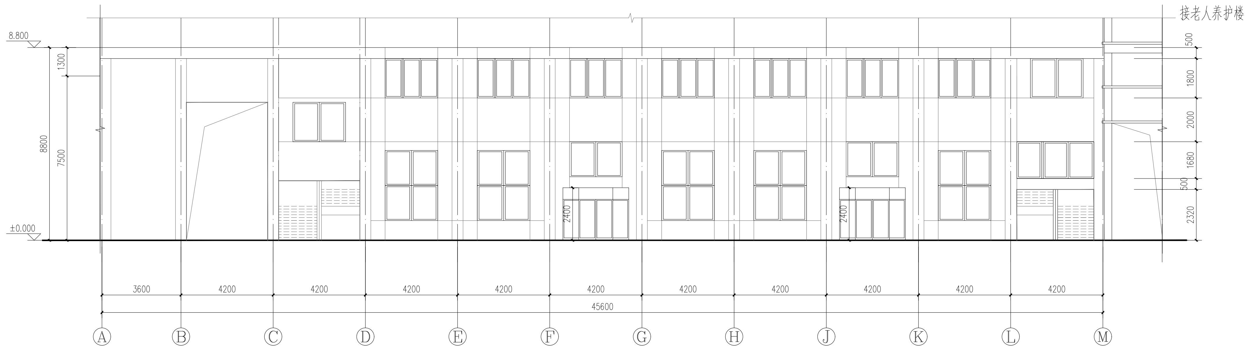
正立面示意图 (改造前) 1:100 说明: 层高H=8.8M
