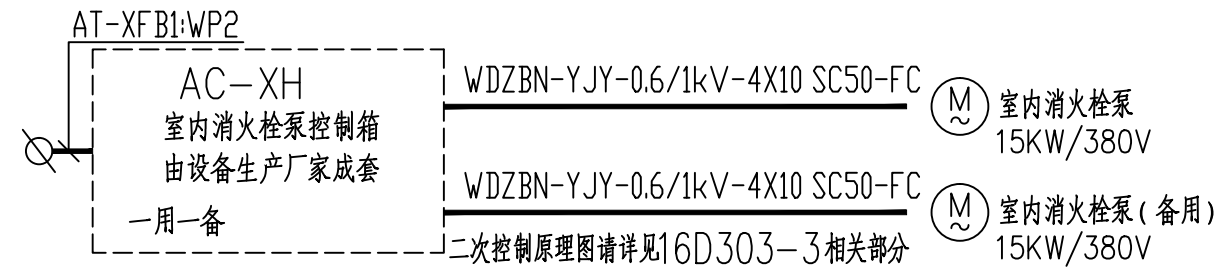
室内消火栓泵控制箱 AC-XH 系统图
