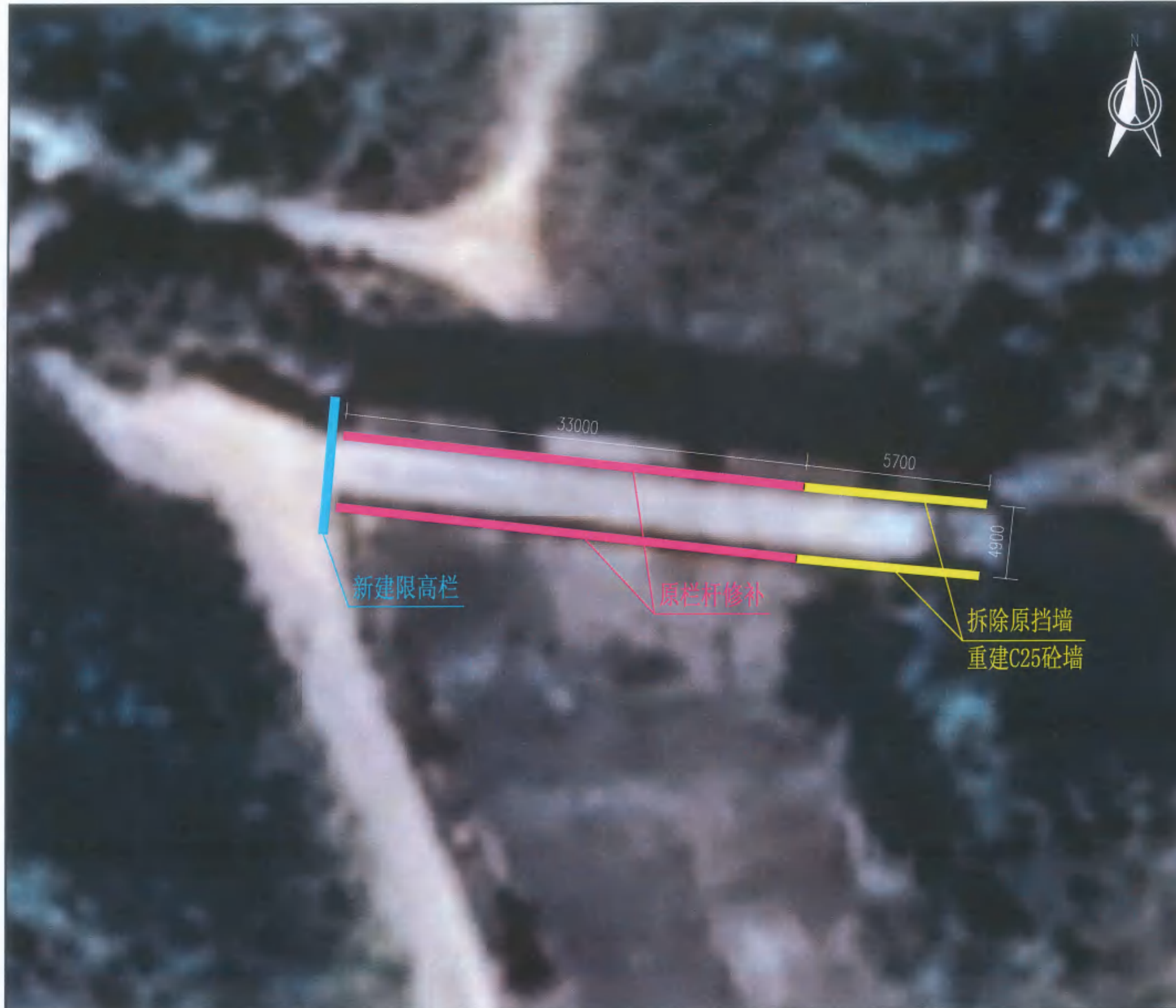
交通桥维修平面图
