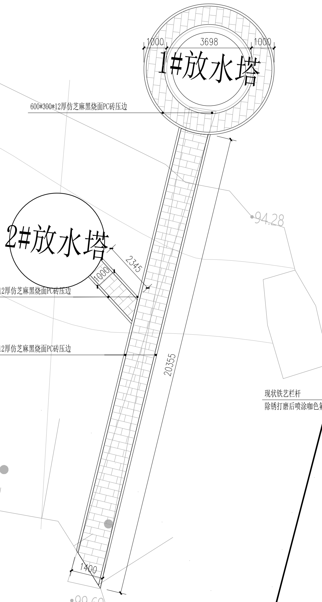
① 放水塔交通桥平面图 1:100
