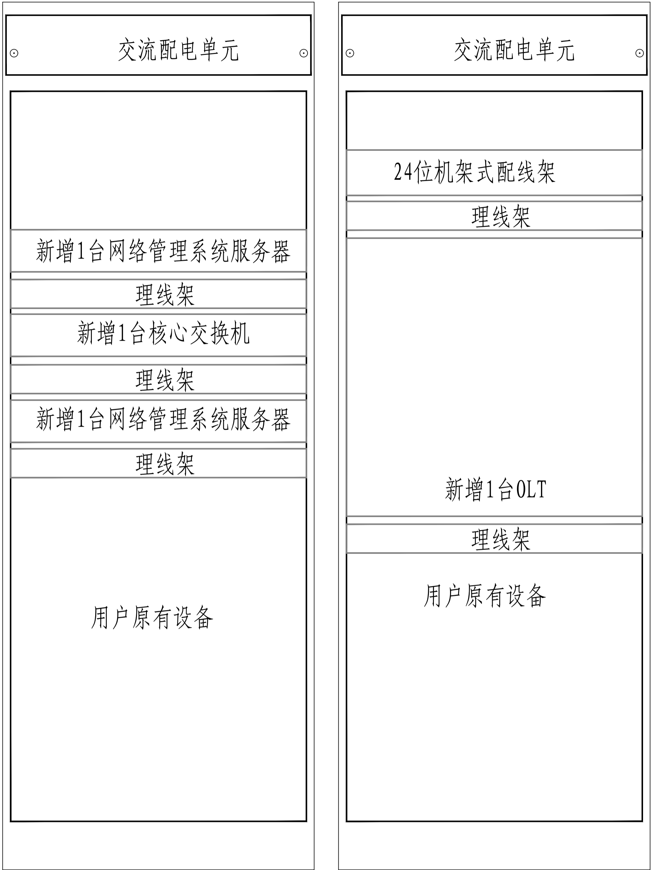
文昌校区信息中心机房机柜布置立面图
